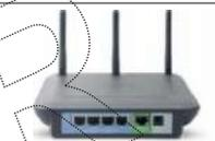
•Access Point es un dispositivo de red que interconecta equipos de comunicación inalámbricos, para formar una red inalámbrica que interconecta dispositivos móviles o tarjetas de red inalámbricas.
