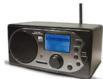
**Parlante portátil:** Es un transductor electro acústico, es decir, convierte energía eléctrica en energía acústica. Esta conversión tiene lugar en dos etapas: la señal eléctrica produce el movimiento del diafragma del **altavoz** y este movimiento produce a su vez ondas de presión (sonido) en el aire que rodea al **altavoz**.
