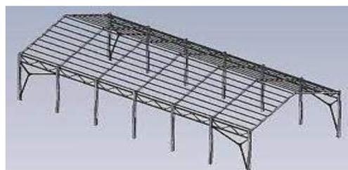
**Estructura de madera (normalizada):** Es un sistema de estructura aporticado cuyos elementos estructurales son vigas, columnas, elementos de arrioste de madera seleccionadas y tratadas, conectados a través de nudos formando pórticos resistentes en las dos direcciones principales. (x e y).
